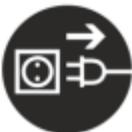
Pred pripojením, alebo odpojením svoriek odpojte napájanie nabíjačky! Iskrenie môže pri nabíjaní vodíka viesť k výbuchu!
